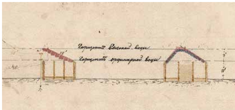
Ил. 31б. Разрез по эскарпу в виде наклонной гранитной вымостки и по ряжевому волнолому на перестраиваемой батарее № 9. РГАВМФ. Ф. 1341. Оп. 4. Д. 4627
