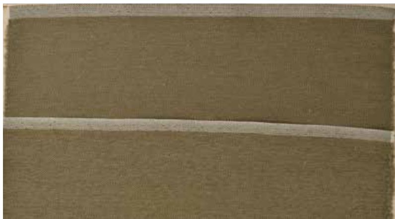
Ил. 4. Закладная кромка (гимнастерочная ткань х/б меланж, изнаночная и лицевая (справа) стороны, копия)
