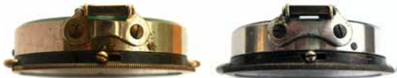
Ил. 4. Слева — компас модели 1911 г. с выступом на кронштейне крепления визира. Справа — компас модели 1911 г. с обычным кронштейном крепления визира. Из коллекции автора
